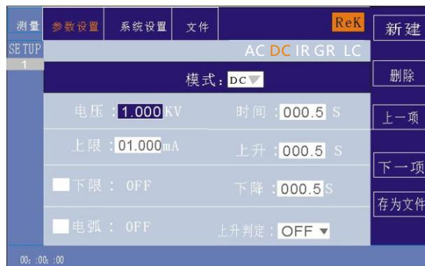
在此界面，按“ENTER”键可对输出电压值进行编辑，输出电压范围为（0.050–6.000）KV。要改变输出电压值，只需输入数字键即可。比如要输入电压2.000KV，只需按数字键“2”和“ENTER”即可。要输入4.750KV，按“4”、“7”、“5”、“0”和“ENTER”键即可。
