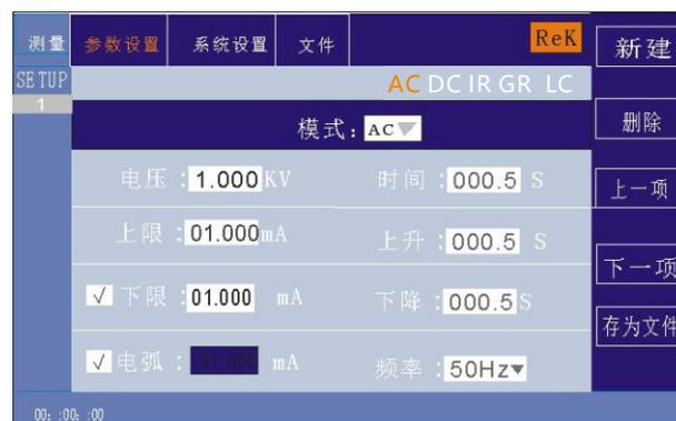
**注：**用“ENTER”键打开或关闭电弧功能，电弧范围：（0.1-50）mA
