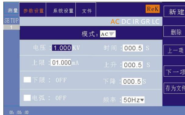
在此界面，按“ENTER”键可对输出电压值进行编辑，输出电压范围为（0.050-5.000）KV。要改变输出电压值，只需输入数字键即可。比如要输入电压2.000KV，只需按数字键“2”和“ENTER”即可。要输入4.750KV，按“4”、“7”、“5”、“0”和“ENTER”键即可。
