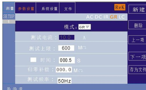
在此界面，按“ENTER”键可对输出电压值进行编辑，输出电压范围为（3-32.0）A。要改变输出电压值，只需输入数字键即可。比如要输入10.0A，按“1”、“0”、“0”和“ENTER”键即可。
