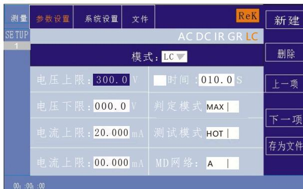
在此界面，按“ENTER”键可对电压值进行编辑，电压范围为（0.1~300）V。要改变电压值，只需输入数字键即可。比如要输入100V，按“1”、“0”、“0”和“ENTER”键即可。
