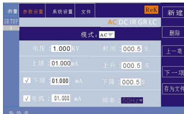
在此界面下，按“ENTER”键可对频率进行编辑，范围为（50/60）Hz。按“↓”“↑”或旋转编码电位器要改变频率值。
