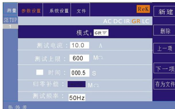
归零补偿分为：AUTO、手动。自动补偿状态只需两根测试线短接后补偿值自动记入到测试仪内部；手动状态时要提前测得线损的补偿值，输入相应的数字值即可。
