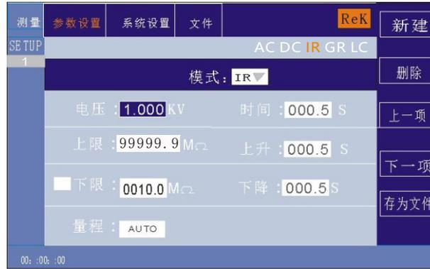
在此界面，按“ENTER”键可对输出电压值进行编辑，输出电压范围为(0.050-3.000)KV。要改变输出电压值，只需输入数字键即可。比如要输入1.000KV，按“1”、“0”、“0”、“0”和“ENTER”键即可。
