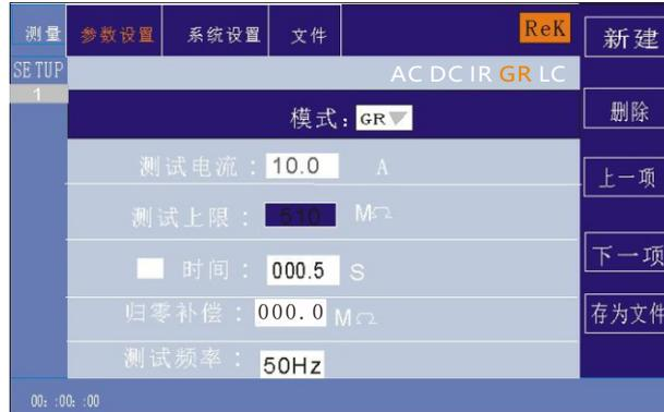
在此界面，按“ENTER”键可对测试上限值进行编辑，范围为（0.1-600）mΩ。要改变电阻上限值，只需输入数字键即可。比如要输入100mΩ，按“1”、“0”、“0”和“ENTER”键即可。
