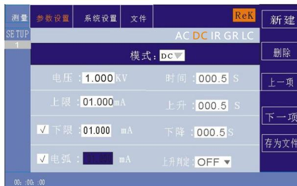
**注：**用“ENTER”键打开或关闭电弧功能，电弧范围：（0.1-20）mA
