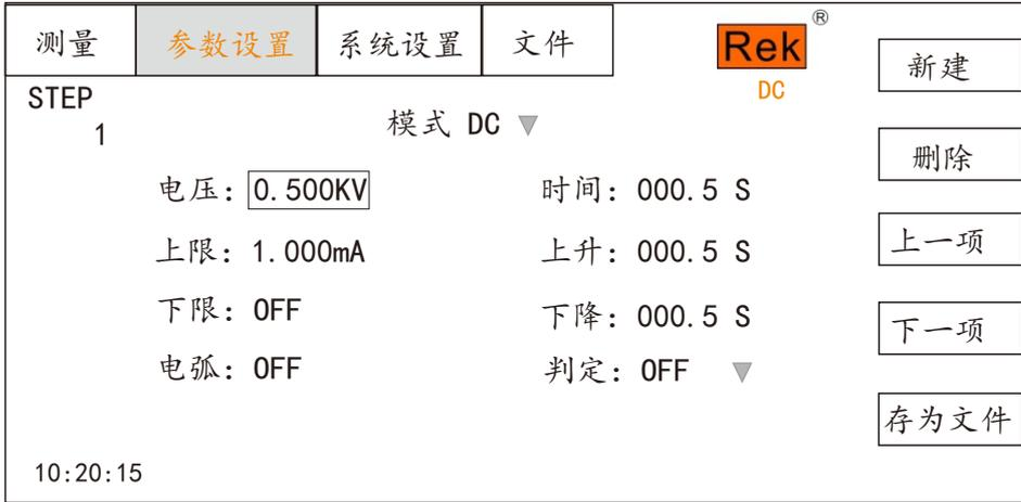
在此界面，按“ENTER”键可对输出电压值进行编辑，输出电压范围为(0.500-10.00)KV。要改变输出电压值，只需输入数字键即可。比如要输入电压2.000KV，只需按数字键“2”和“ENTER”即可。要输入4.750KV，按“4”、“.”、“7”、“5”和“ENTER”键即可。
