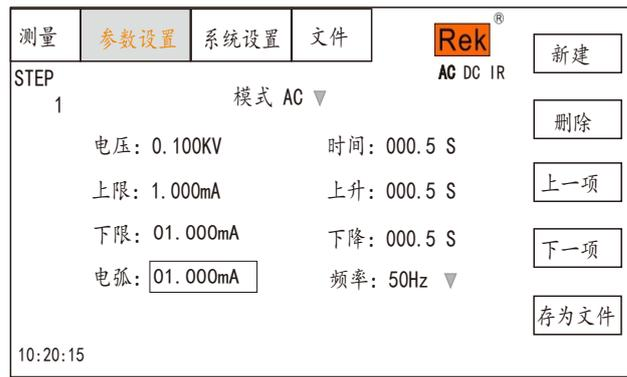
**注：**用“ENTER”键打开或关闭电弧功能，电弧范围：（0.1-20）mA
