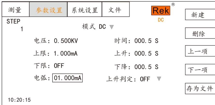
**注：**用“ENTER”键打开或关闭电弧功能，电弧范围：（0.1-20）mA
