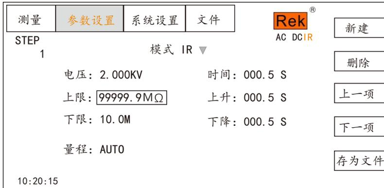
在此界面，按“ENTER”键可对电流上限值进行编辑，范围为（0.1-99999.9）MΩ。要改变电流上限值，只需输入数字键即可。比如要输入0.515mA，按“0”、“5”、“1”、“5”和“ENTER”键即可。
