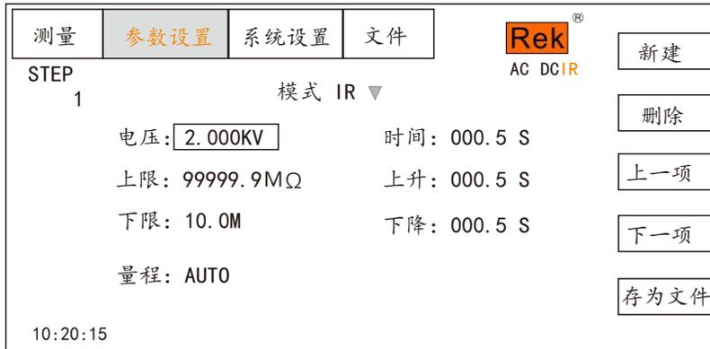
在此界面，按“ENTER”键可对输出电压值进行编辑，输出电压范围为（0.050-5.000）KV。要改变输出电压值，只需输入数字键即可。比如要输入2.000KV，按“1”、“0”、“0”、“0”和“ENTER”键即可。
