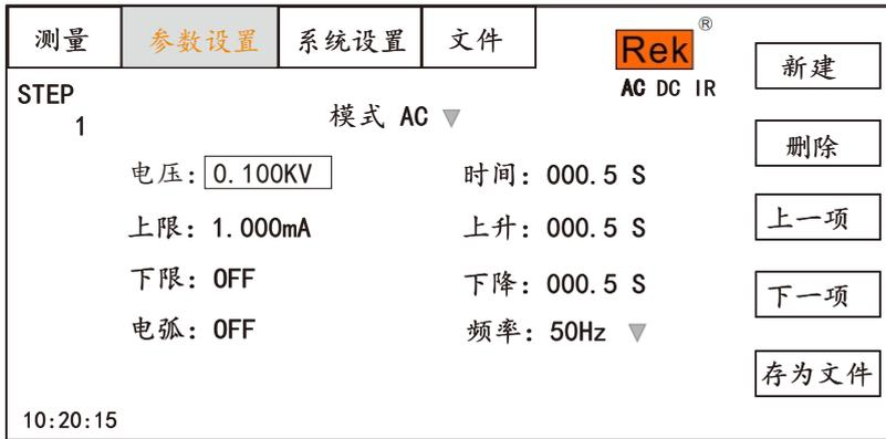
在此界面，按“ENTER”键可对输出电压值进行编辑，输出电压范围为（0.100-10.00）KV。要改变输出电压值，只需输入数字键即可。比如要输入电压2.000KV，只需按数字键“2”和“ENTER”即可。要输入4.750KV，按“4”、“7”、“5”、“0”和“ENTER”键即可。
