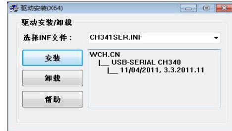
**步骤2：**选择 CH341SER.INF，单击安装，安装成功后会弹出提示窗口，如右图所示。
