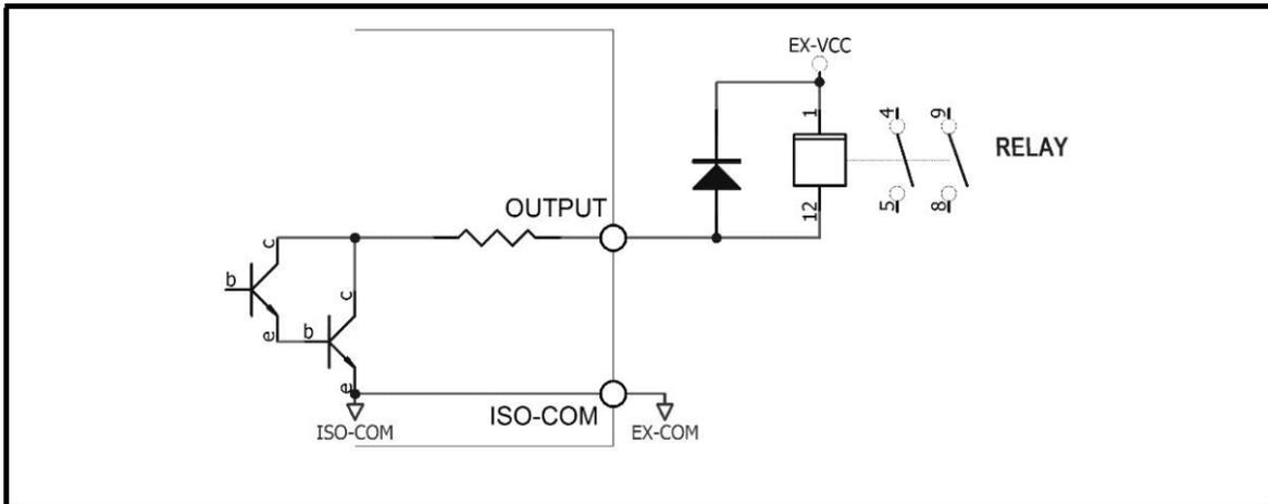
控制发光二极管或光电耦合器
