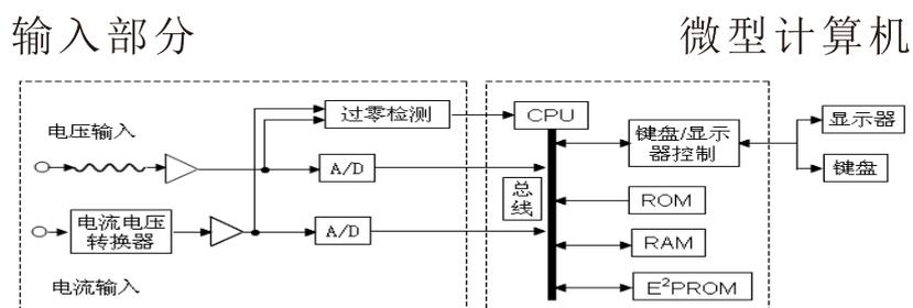
仪器主要由输入（电压输入和电流输入电路）、微型计算机、显示和接口部分组成。
